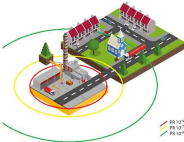
Figure 3-1 Ejemplo de zonas de seguridad que incluyen el contorno PR 10^{-4} , 10^{-7} y 10^{-8} (a modo ilustrativo)
